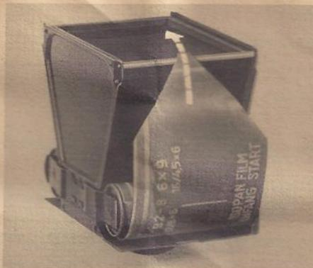
Film B 2-8 (120) unten einsetzen. Zapfen der federnden Bleche müssen beiderseits in Spulenlochung eingreifen.
